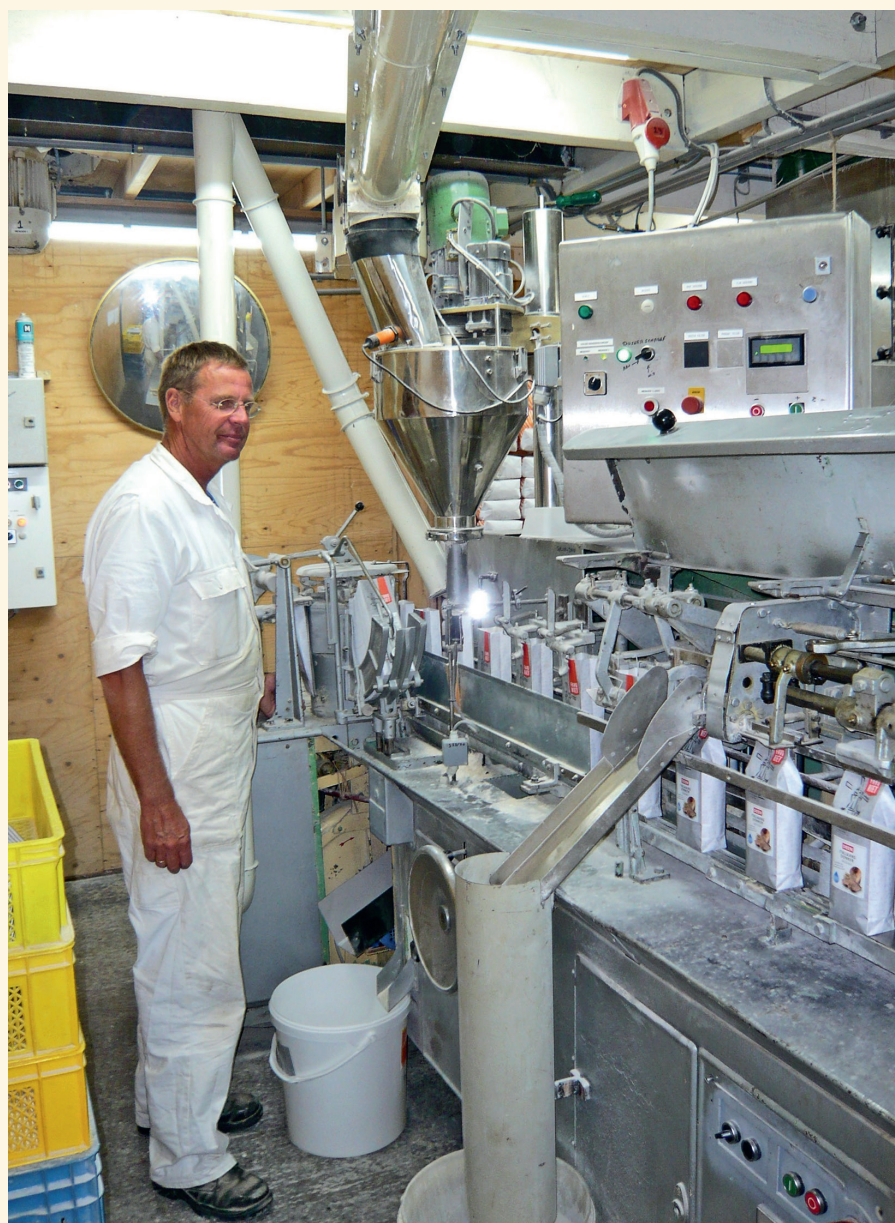
Molenaar Erik Dudink aan het werk bij een inpakmachine. Hij nam deze machine, die uit de jaren 60 dateert en puur mechanisch werkt, over uit de suikerindustrie. De machine verricht alle noodzakelijke bewerkingen: afwegen, vullen, papier afsnijden en sealen.
