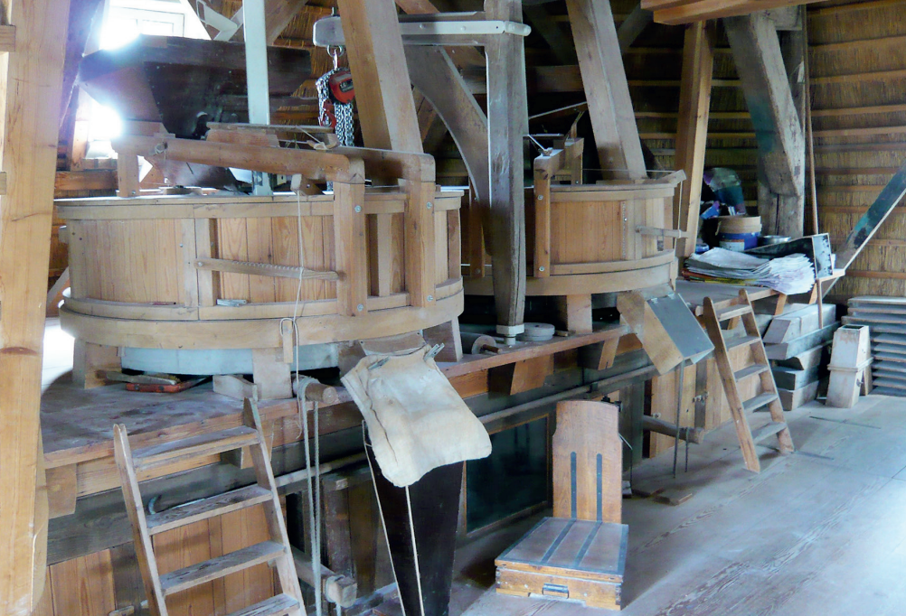
Op de maalzolder (op stellingniveau) liggen de stenen op een halfzolder. Het linkse koppel wordt door een elektromotor aangedreven, en het rechtse kan op windkracht draaien.
